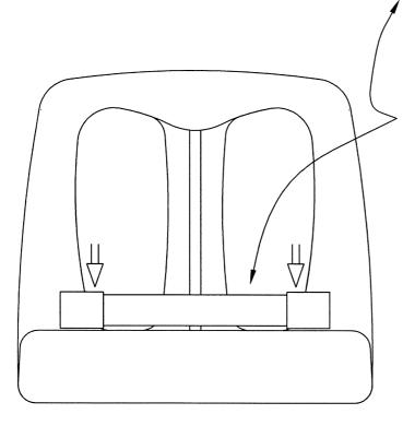
PULL UP ON THE TUBE AND SLIDE IT AGAINST THE PALM SUPPORT PAD.
